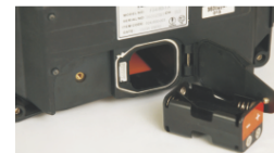
Instalación de la batería
